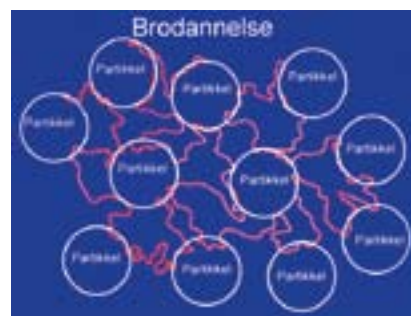
Ved flokkulering opstår brodannelse ved, at polymeren adsorberer til enkeltpartikler.
