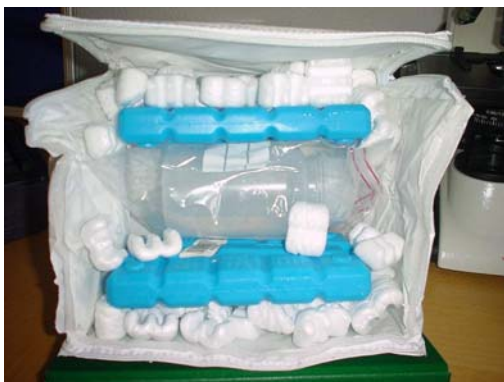
Tværsnit af en korrekt pakket forsendelse
