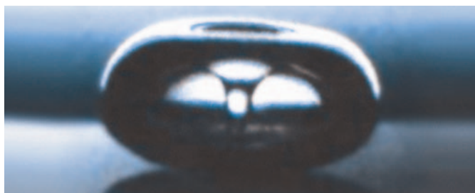
En mange gange forstørret kavitations boble ved implosionstidspunktet.
